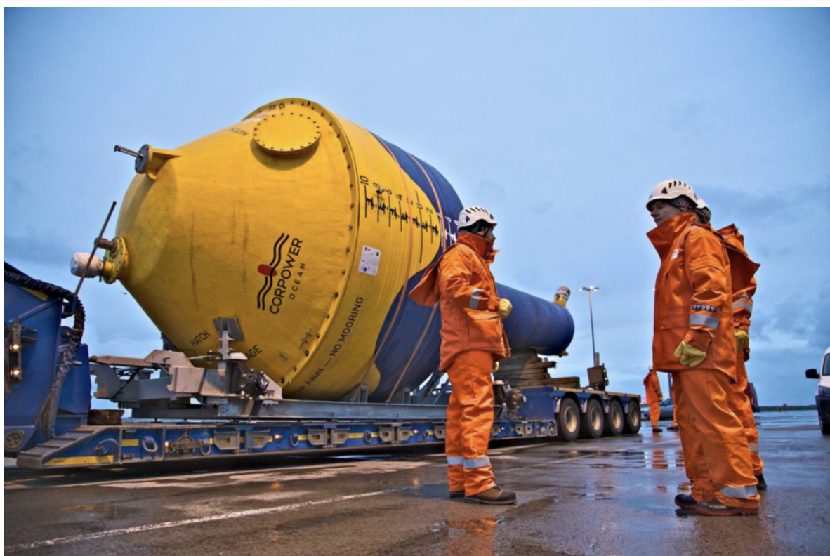
Bøya er 9 meter bred, 18 meter lang og veier 60 tonn, og kan produsere med en topplasteffekt på mist 300 kW. Foto: CorPower Ocean
